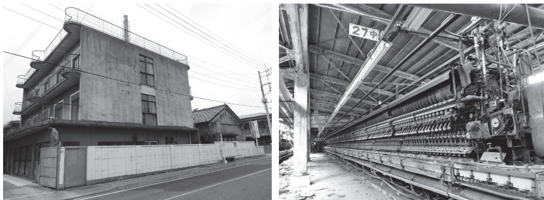
写真8 山梨県内の器械製糸工場跡（左はモダンな女子寮が残る外観、右は日産自動車製繰糸機が並ぶ工場跡の内部〔手前の「27中」と記された吊り札は、設定された糸の太さを示す〕）
