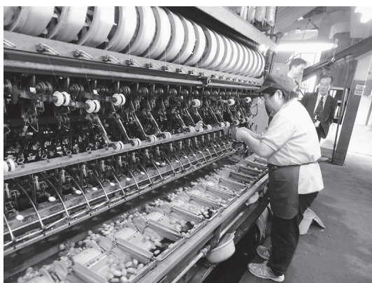
写真4 日産自動車製自動繰糸機が稼働する松岡(株)の工場
