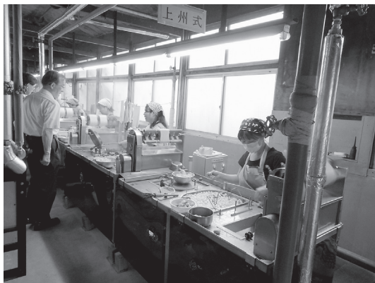
写真6 上州式座繰方式の製糸工程（宮坂製糸所）
