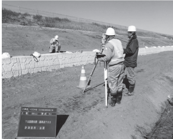
図4 トータルステーションでの測量の様子例
